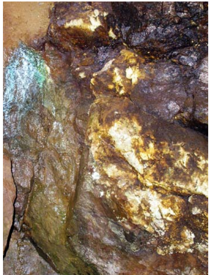
Den gröna missfärgningen tyder på naturligt bildad ärg, det vill säga kopparhaltigt berg, vilket är intressant vid prospektering.
